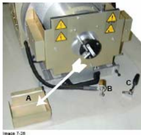
图 8-21 卸除阴极盖板
