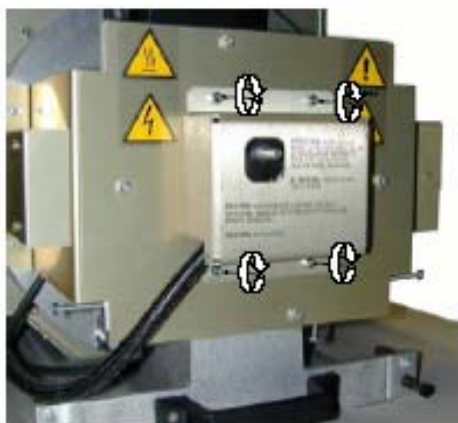
图 8-38 阴极盖板安装
