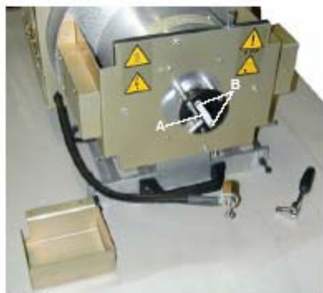
图 8-22 卸除阴极压板
