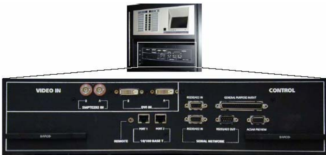
图 8-6 数字放映机的输入面板
