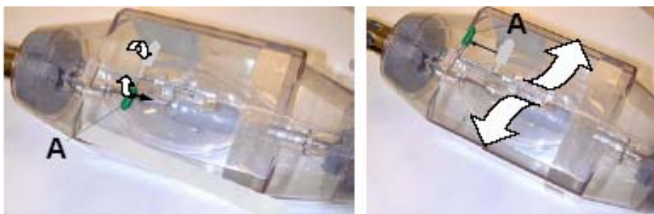
图 7-35 保护盖的解锁和卸除
