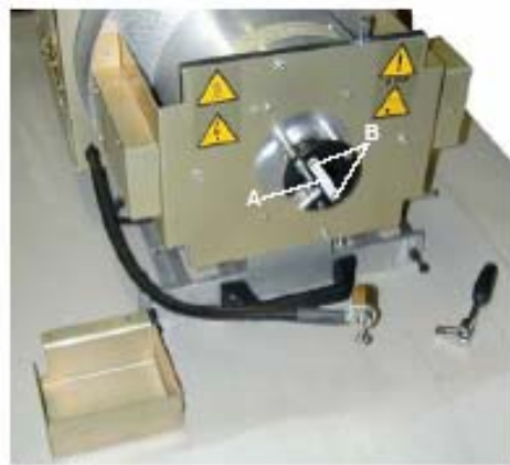
图 7-27 卸除阴极压板
