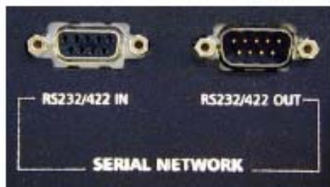
图 8-9 D9 插座(输入) - D9 插头(输出)
