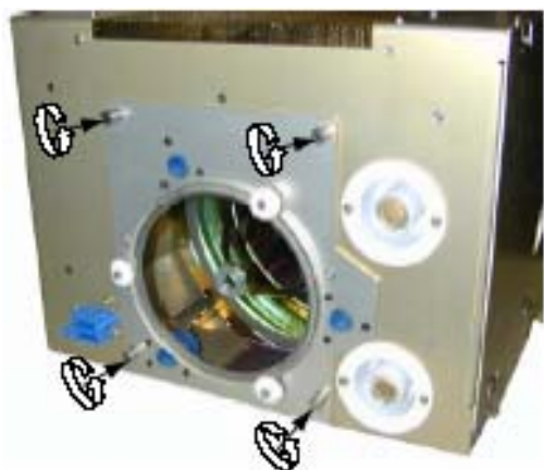
图 7-23 松动紫外滤光器组件上的固定螺丝
