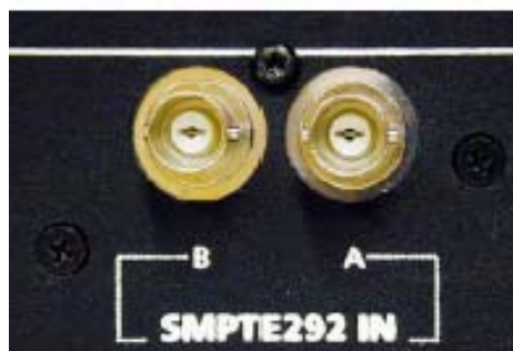
图 8-7 同轴电缆连接器
